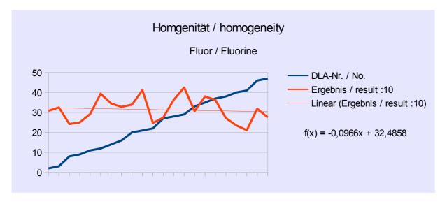
Abb./Fig. 7: Trendfunktion Probennummern vs. Fluor Ergebnisse (1/10 dargestellt) trend line function sample number vs. fluorine results (1/10 shown)
