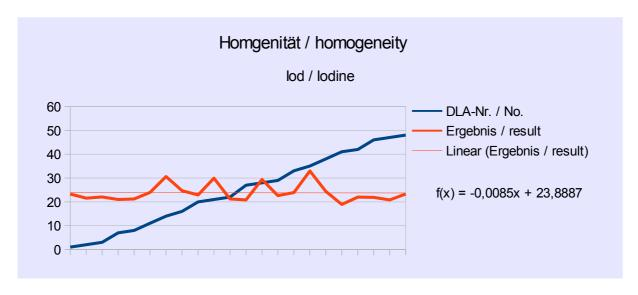
Abb./Fig. 8: Trendfunktion Probennummern vs. Iod Ergebnisse trend line function sample number vs. iodine results
